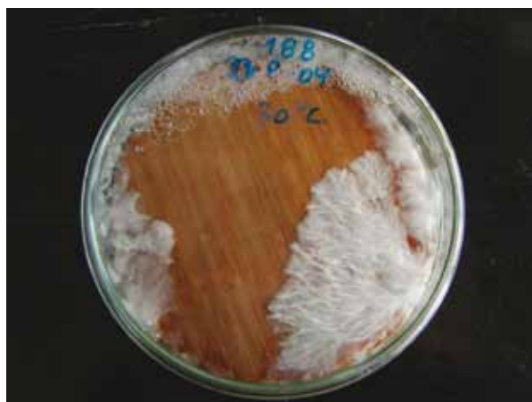
Figura 5. Chapa de E. globulus atacada por el hongo H188
